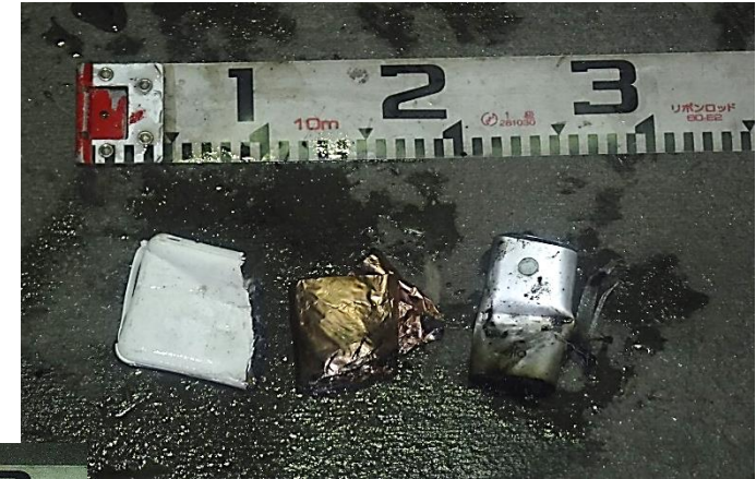
発火元となった充電式電池
