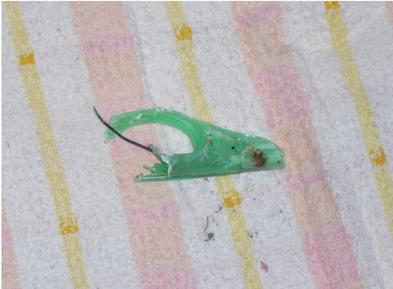
発火元と思われるガスライターの破片
